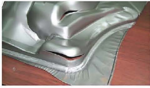
精確預測某發動機罩內板的斷裂區域
